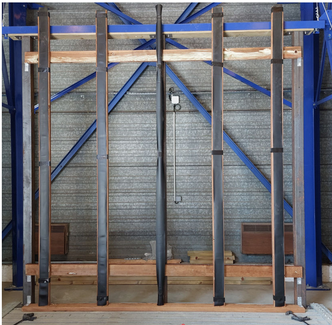
Photo 3 : Structure support en bois avec joints d'étanchéité
